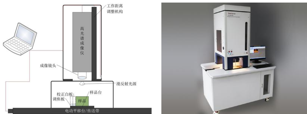
图 1 GaiaSorter 高光谱分选仪结构图与实景图
